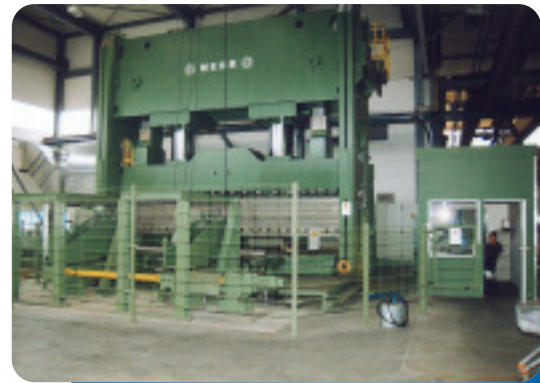
Presse 4000t Rohre bis 6000 mm Läng, bis 50 mm Wandstärke/press 4000t pipes l = 6000 mm, t = 50 mm
