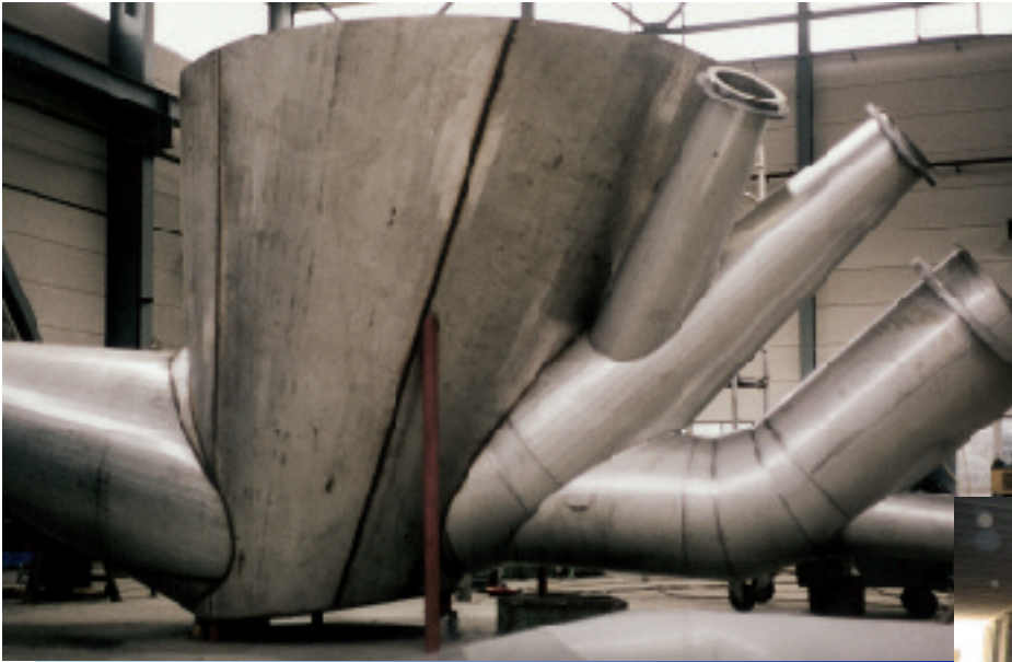
Behälterunterteil mit Stützen/ Bottom part of vessel with welded in-outlets
