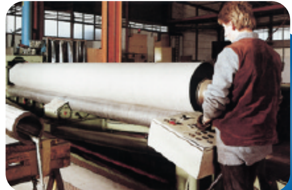
Ein- und Rundwalzen von Rohren L = 6000 mm, S = 15 mm Roll Forming, L = 6000 , t = 15 mm
